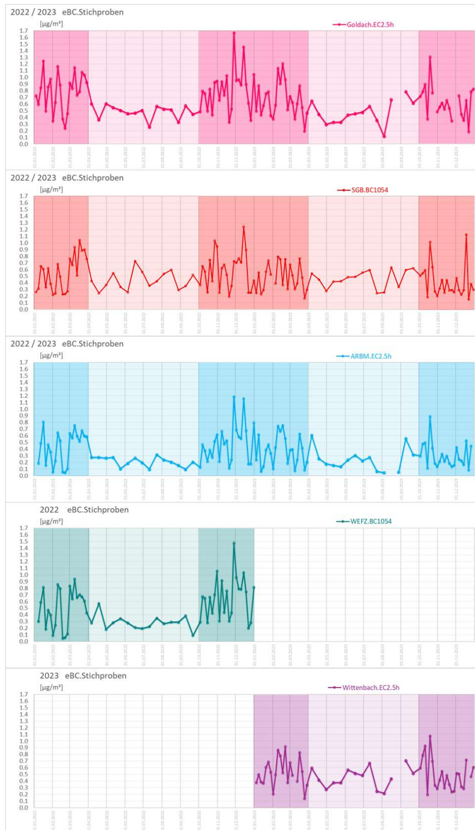
Abb. 23: eBC-Tagesmittelwerte an den fünf Messtandorten; dunkel: Winter (Probenahme alle vier Tage, um möglichst viele Filter bei Inversionslagen sammeln zu können), hell: Sommer (Probenahme alle zwölf Tage)
