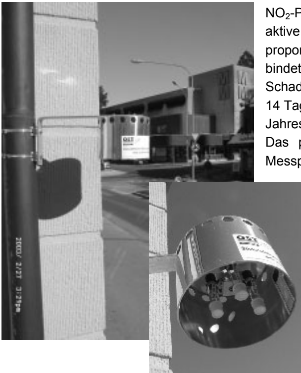
Abb. 11: Aufhängevorrichtung und Schutzbehälter mit drei Passivsammlern
