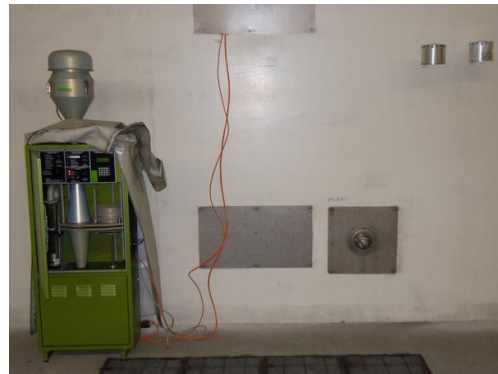
Abb. 5 Messeinrichtung unter der Fahrbahn des Islisbergtunnels beim Ausfahrtsportal in Wettswil am Albis (links) HiVol-Feinstaubsammler während Servicearbeiten und NO 2 -Passivsammler im Innern des Tunnels (rechts)
