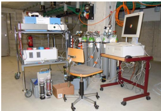
Abb. 5 Messeinrichtung unter der Fahrbahn des Islisbergtunnels beim Ausfahrtsportal in Wettswil am Albis (links) HiVol-Feinstaubsammler während Servicearbeiten und NO 2 -Passivsammler im Innern des Tunnels (rechts)
