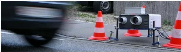
Abb. 1 Remote Sensing Detector (RSD) 1 im Einsatz an der Hauptstrasse in Gockhausen (ZH) (Messungen von AWEL)
