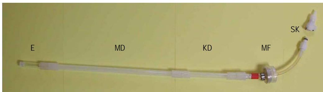
Abbildung 45 Foto einer Messanordnung bestehend aus Einlaufstrecke E, Minidenuder MD, Kontrolldenuder KD, Minifilter MF und Schnellkupplung SK - Midefix
