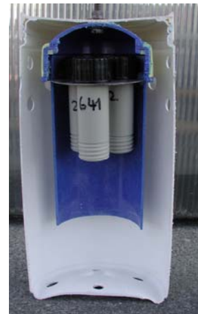
Abbildung 46 links Zürcher-Passivsammler, schematisch dargestellt, Höhe 64 mm, Durchmesser aussen 20 mm, Durchmesser innen 9 mm
